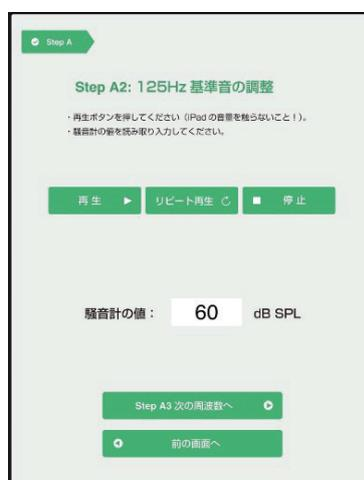
図 13 125Hz 基準音画面（再生ボタンをタップし、騒音計の値を読み取り入力する）
