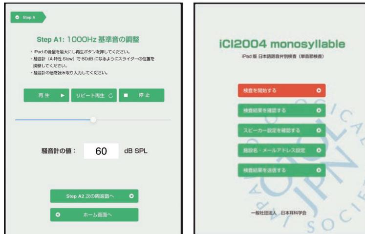
図 12 左：1000Hz 基準音画面（スライダを調整して 60dB SPL となるよう調整する）
